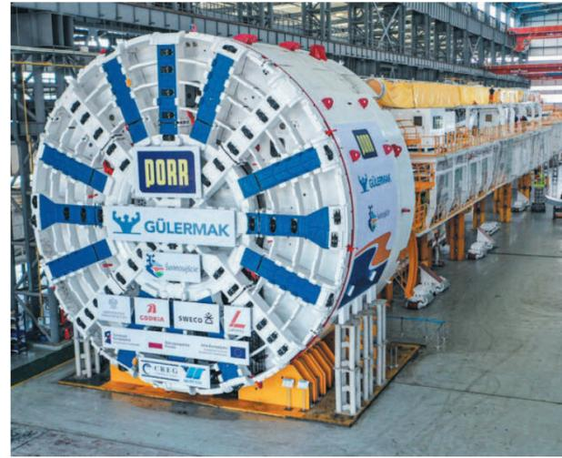
O tatuzão vai escavar um túnel de 12m de diâmetro e 8 km de extensão
