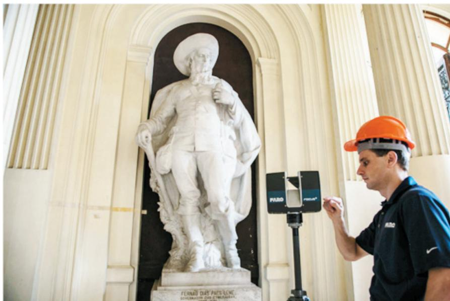
Digitalização contou com a captação das imagens usando scanners a laser
